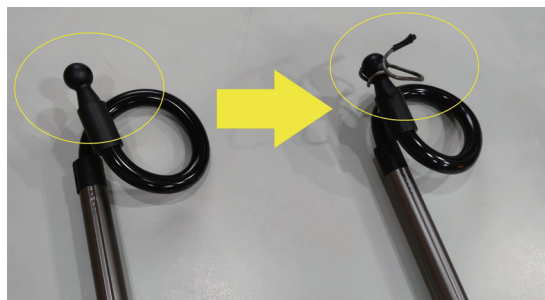
圖 3、將找到適合的手機平板支架使用鐵絲加裝點滴勾
